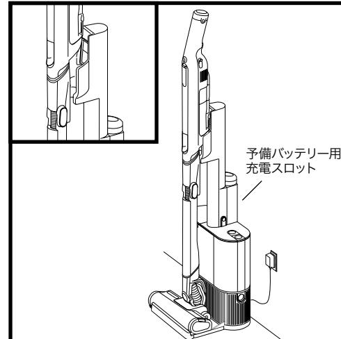
掃除機本体を自動ゴミ収集ドックのダクトに掛けて収納します。正しく収納されると掃除機本体のLEDインジケーターが点灯します。
