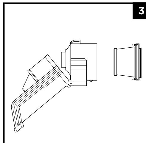
3. フィルター容器からフィルターを引き出します。フィルターとフィルター容器は、水のみを使用して手洗いし、24時間以上自然乾燥させてください。フィルターを取り付けるには、再度フィルター容器の中へ戻し、カチッと音がするまで押し込んでください。
