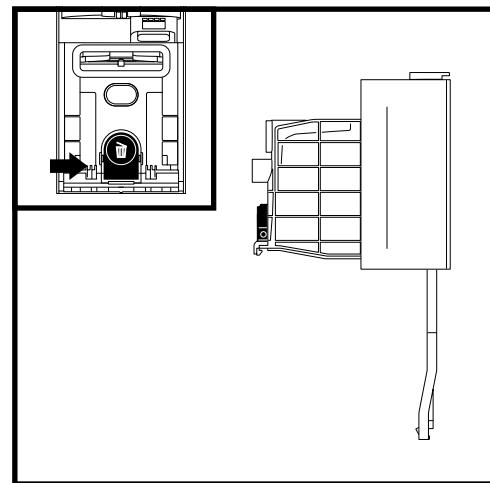
ダストカップを空にするには、ゴミ袋などの中で、ゴミ箱アイコンの付いたリリースボタンを押します。ダストカップのフタが開き、ゴミが放出されます。軽く叩いてダストカップ内に残っているゴミを取り除きます。
