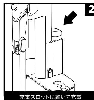
掃除機本体を自動ゴミ収集ドックに正しく置くと、本体のインジケーターライトが点滅し、充電が開始されたことを示します。
