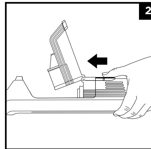
2. 電源がオフ、かつダストカップが開いた状態でダストカップ底部のフィルターリリースボタンを押し、フィルター容器を引き出します。
