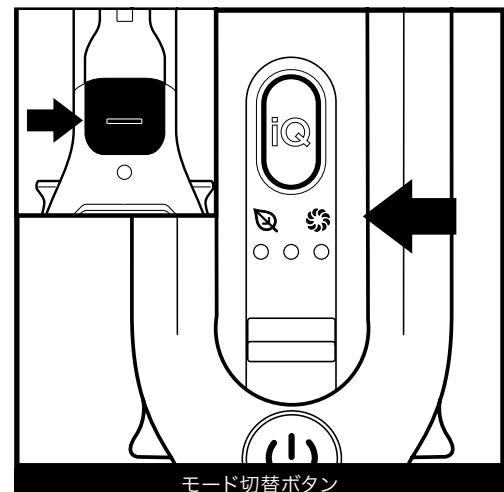
より強力な吸引力を発揮するブーストモードに切り替えるには、ハンドル裏面のボタンを押し続けます。ブーストモード時にはブーストモードのインジケーターが点滅します。ボタンを離すと、直前のモードに戻ります。
