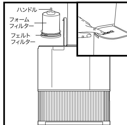
フォームフィルターとフェルトフィルターは、ドック正面から見て左側上部にあります。フタを開け、ハンドルでフォームフィルターを持ち上げてから、下にあるフェルトフィルターを取り外します。フィルターは1ヶ月に一度、水のみを使用して手洗いし、24時間以上自然乾燥させてから再度取り付けてください。汚れが気になる場合は、洗浄の合間にフィルターのゴミを軽く叩き落としてください。
