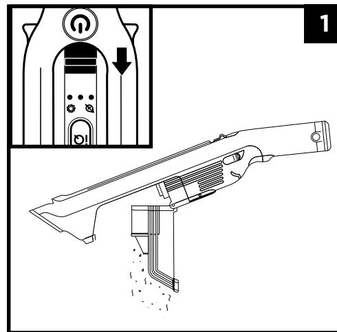
1. 電源がオフの状態で、ゴミ捨てボタンを前方にスライドさせると、ダストカップが開きます。ダストカップにゴミが残っているとゴミが飛び散る場合がありますので、ゴミ箱の上にかざしてダストカップを開いてください。
