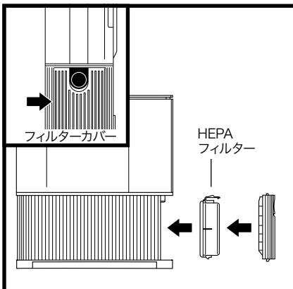
HEPAフィルターは、ドック正面から見て右側面にあります。フィルターカバーの上部にあるボタンを押しながらカバーを傾けて外し、HEPAフィルターを取り外します。HEPAフィルターを軽く叩いてほこりや異物を取り除き、再度取り付けてください。
