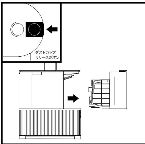
自動ゴミ収集ドックのダストカップは、最大30日分のほこりやゴミをためておくことができます。ゴミの量がMAXラインに近づいたら、ドックのダストカップを空にします。
