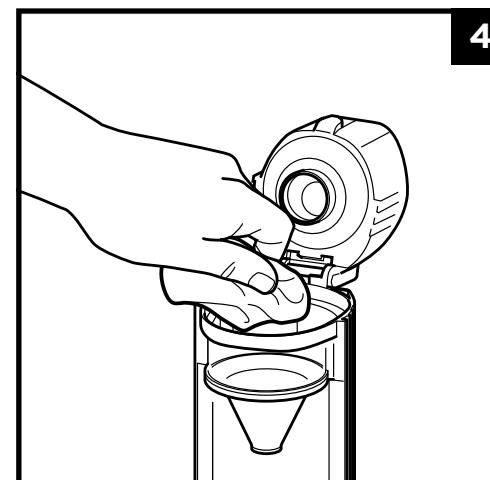
4. 取り外したダストカップは、水で洗うか湿らせた布で拭いてください。洗浄後は十分に自然乾燥させてください。
