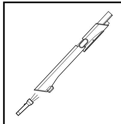
電動フロアノズルの点検方法:
