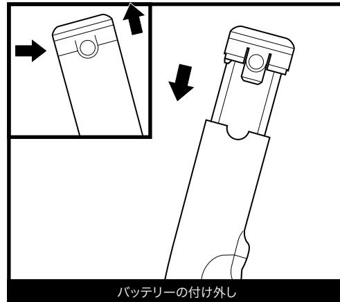
バッテリーを掃除機本体や充電スロットから取り外す場合は、バッテリーのキャップ部にあるタブを押しながら、バッテリーを引き出します。再び取り付けるには、バッテリーをスライドさせながら元の位置に差し込みます。
