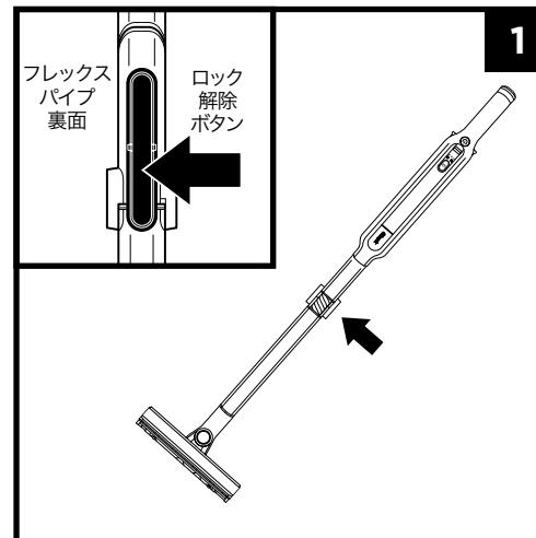
フレックスパイプ裏面の上部にあるロック解除ボタンを押すと、パイプを曲げることができます。
