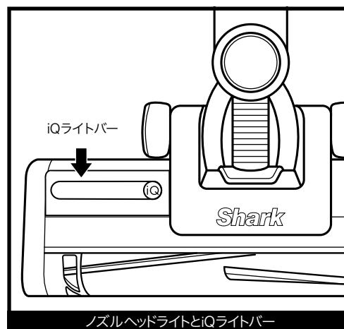
スティック掃除機としてご使用の場合はノズルのヘッドライトが点灯します。
