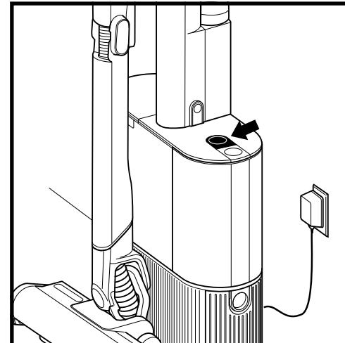
通常、掃除機本体がドックに装着されたときにダストカップ内のゴミが自動収集されます。この機能をオフにする場合は、ドック上部にある「自動ゴミ収集停止ボタン」を押してください。アイコンが点灯している間は掃除機本体をドックに戻してもゴミの自動収集は行われず、充電のみが行われます。ゴミの自動収集を再開するには、再度ボタンを押してください。
