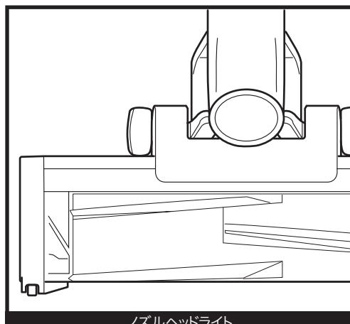
スティック掃除機としてご使用の場合はノズルのヘッドライトが点灯します。
