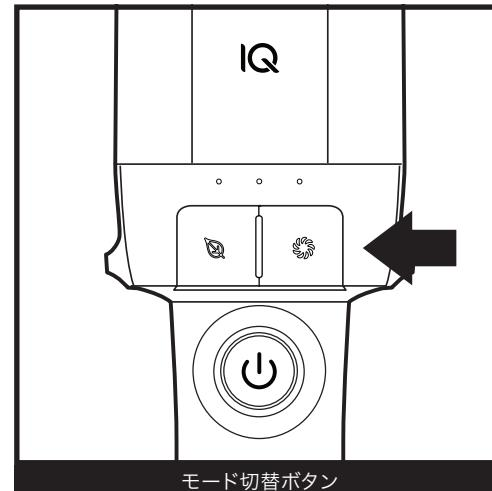
より強力な吸引力を発揮するブーストモードに切り替えるには、ブーストモードのボタンを押して切り替えます。ブーストモード時にはブーストモードのインジケーターライトが点滅します。ボタンを再度押すとiQモードに戻ります。
