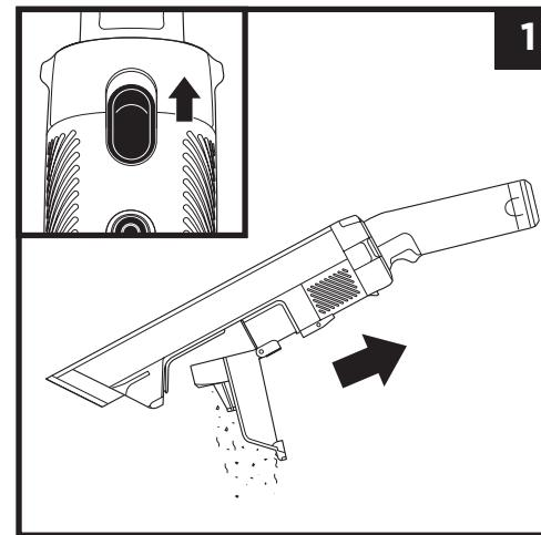
1. 電源がオフの状態で、ダストカップをゴミ箱の上にかざします。掃除機裏側のゴミ捨てボタンを手前にスライドさせると、ダストカップが開きます。
