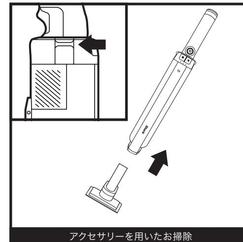
用途に合わせてアクセサリーを選び、掃除機に取り付けてお使いください。アクセサリーを使用する場合は、カチッと音がするまで差し込んでからご使用ください。取り外す際は持ち手の両側にあるつまみを引き上げながらアクセサリーを抜きます。
