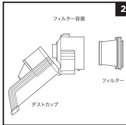
1. 電源がオフ、かつダストカップが開いた状態でダストカップ底部のフィルターリリースボタンを押し、フィルター容器を取り出します。
