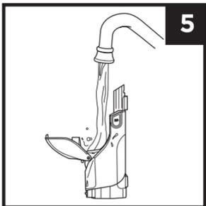
5. ダストカップ内部は水できれいに洗い流します。洗浄後はふたを開けた状態で、24時間以上、十分に自然乾燥させます。
