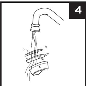
4. フィルターは水で洗い、24時間以上自然乾燥させてください。乾かし方は自然乾燥のみとし、ヘアドライヤーや乾燥機は絶対に使わないでください。
