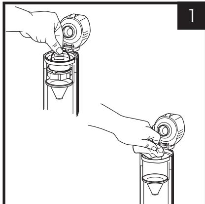
サイクロンの金属リングを持って、ゆっくりとダストカップから取り外します。サイクロンが取り出しづらい場合は、ダストカップのフィルター容器部分をカチッと音がするまで開いてください。取り外したサイクロンとダストカップは、水で洗うか湿らせた布で拭いてください。洗浄後は十分に自然乾燥させてください。
