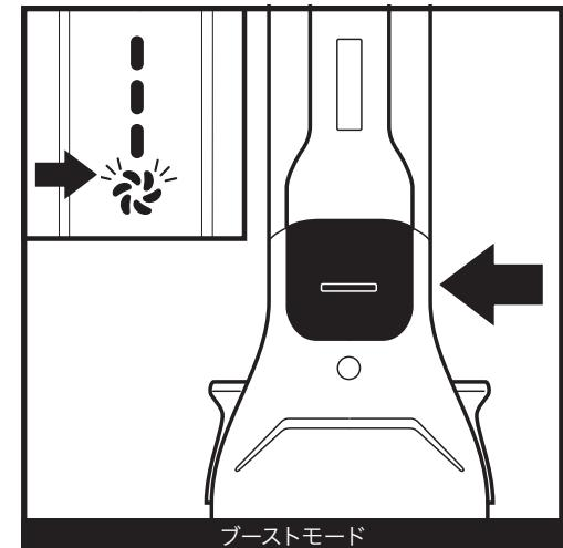
より強力な吸引力を発揮するブーストモードに切り替えるには、ハンドル裏面のボタンを押し続けます。ブーストモード時にはブーストマークのインジケーターが点滅します。ボタンを離すと、通常のモードに戻ります。
