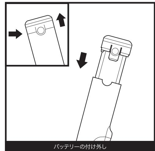
バッテリーを掃除機本体や充電ポストから取り外す場合は、バッテリーのキャップ部にあるタブを押しながら、バッテリーを引き出します。再び取り付けるには、バッテリーをスライドさせながら元の位置に差し込みます。
