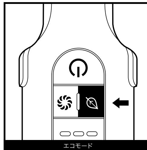
作動音の小さいエコモードに切り替えるには、エコボタンを押します。標準モードに戻すには、もう一度ボタンを押しします。
