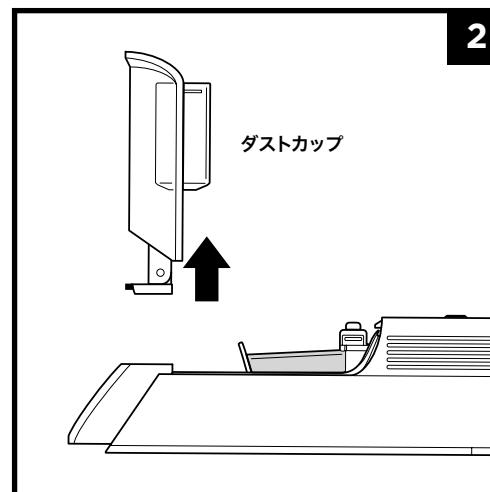
2. ボタンを押したままダストカップを引き出します。ダストカップは洗剤と水で手洗いし、自然乾燥させます。再び取り付ける際には、完全に乾いていることを確認してください。
