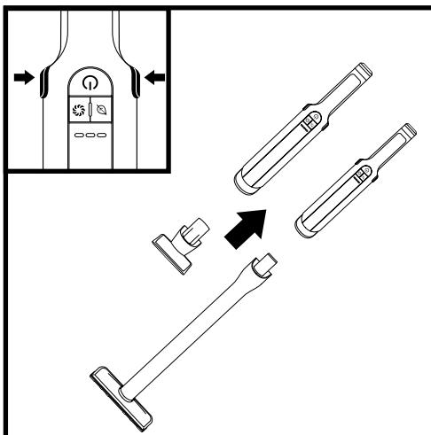
アクセサリーを掃除機本体に取り付けるには、ノズル開口部側からスライドさせるように差し込みます。
