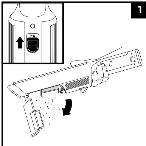
1. 電源がオフの状態で、ダストカップをゴミ箱の上にかざします。底面のゴミ捨てボタンを手前にスライドさせると、ダストカップが開きます。
