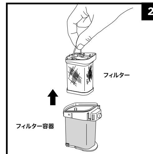
2. フィルターを取り出すには、ゴミ箱の上で金属リングを持ってフィルター容器からフィルターを引き出します。フィルターとフィルター容器を軽くはたいてゴミやほこりを落としてから水ですすぎます。再び取り付ける際には、完全に乾いていることを確認してください。
