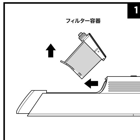
1. 電源がオフ、かつダストカップが開いた状態でフィルター容器を上に持ち上げるようにして取り外します。
