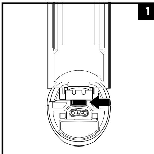
1. 電源がオフ、かつダストカップが開いた状態でダストカップ底部のリリースボタンを押します。
