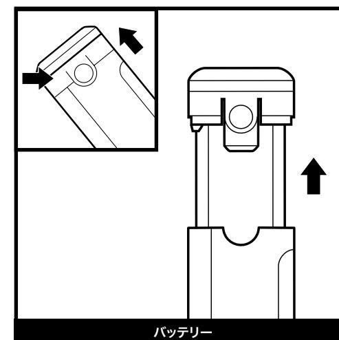
バッテリーを掃除機本体から取り外す際は、バッテリーのキャップ部にあるタブを押しながら、バッテリーを引き出します。再び取り付けるには、バッテリーをスライドさせながら元の位置に差し込み、カチッと音がするまで押します。
