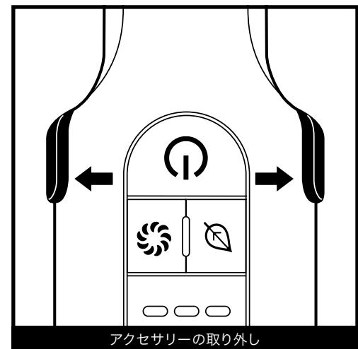
掃除機本体に取り付けたアクセサリーを取り外すには、持ち手の両側にあるワンタッチリリースボタンを左右同時に押します。
